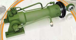
레이더 위치제어 유압 실린더 부하조건 : 220Kg 처짐 방지 PILOT 체크 밸브 내장
